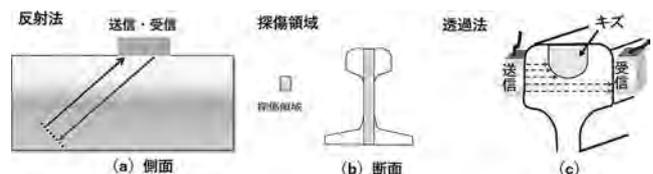
図-2 反射法・探傷領域・透過法
