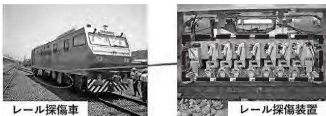
図-1 レール探傷車とレール探傷装置
