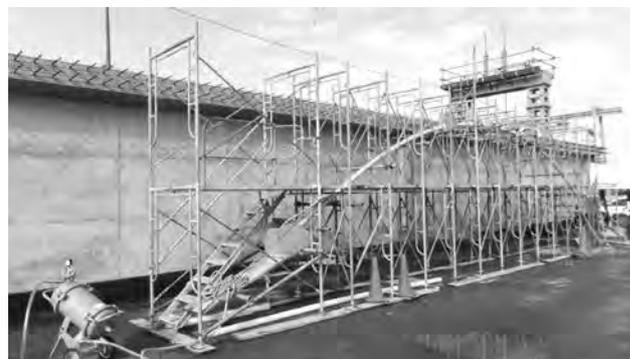
写真一六 実物大 PC グラウト試験状況
