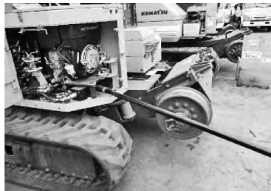
写真—7 手動油圧ポンプ
