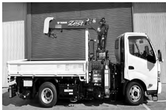
写真—2 自積載トラック
