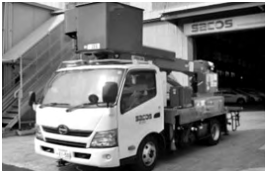
写真—5 高所作業車
