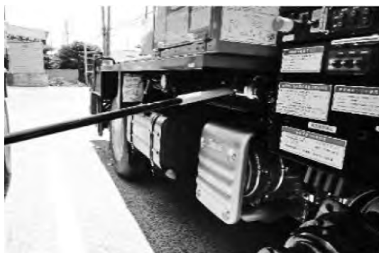
写真—10 手動油圧ポンプ
