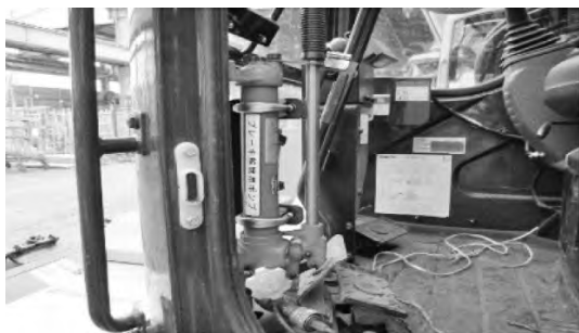
写真一 14 油圧ショベルの保安ブレーキ用油圧ポンプ
