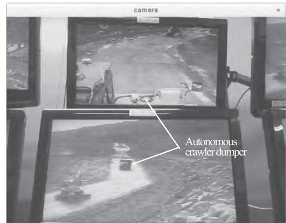
図-8 クローラダンプの自律走行実験中のモニタ映像の写真
