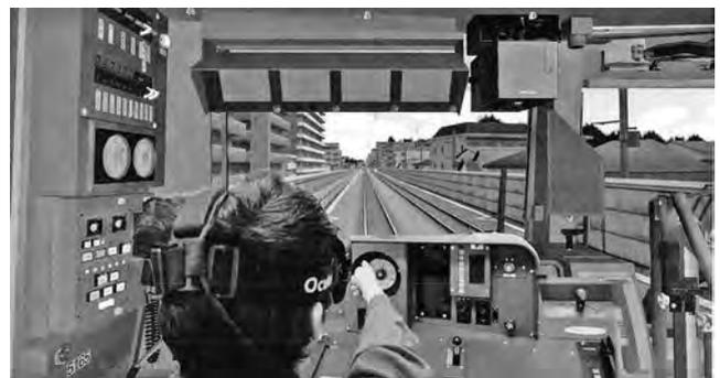
写真—1 ヘッドマウントディスプレイを利用したシミュレータ①
