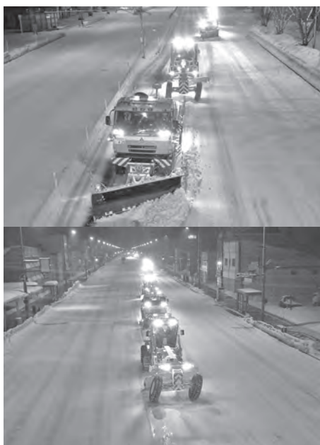
写真一11 国道除雪風景 【除雪トラック（トラックグレーダ装置付）、除雪グレーダ】
