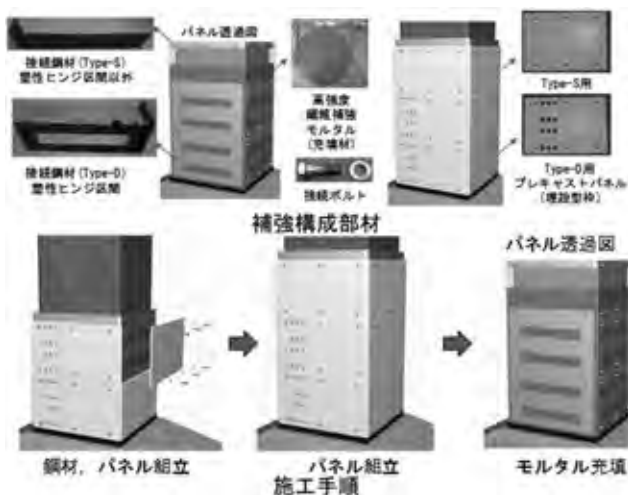
図-8 CBパネルの部材と施工手順
