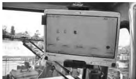
写真—4 オペレータ誘導モニター画面
