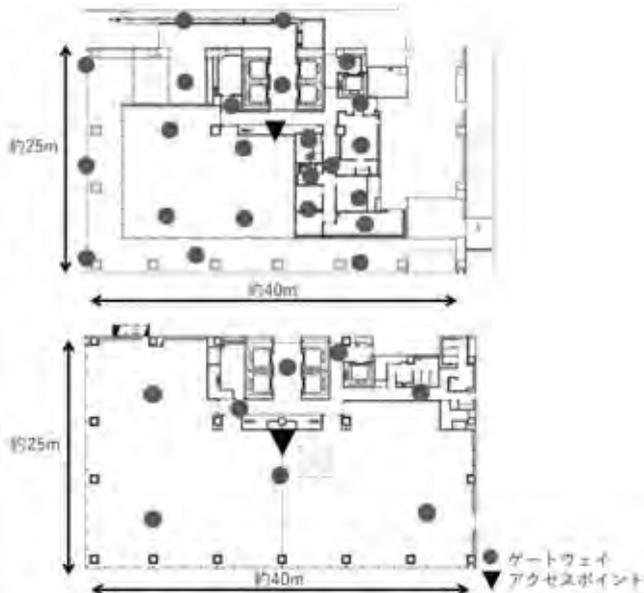
図一八 ゲートウェイの配置計画 (上: 1階, 下: 基準階)
