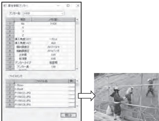
図-2 属性情報および施工写真表示例
