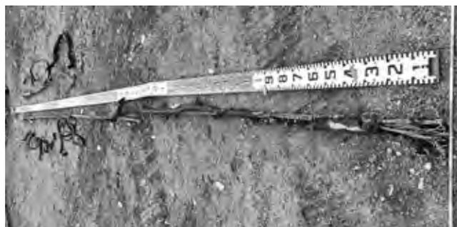
写真-2 回収された鋼線
