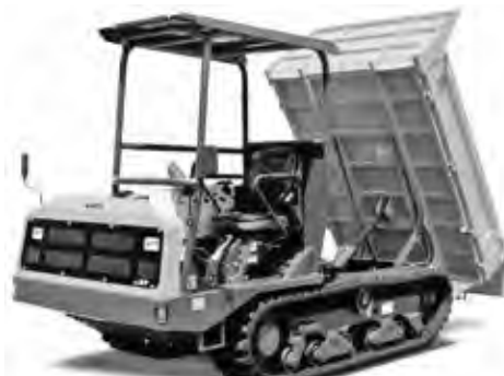
写真—2 加藤製作所 IC37 不整地運搬車 (クローラ式)
