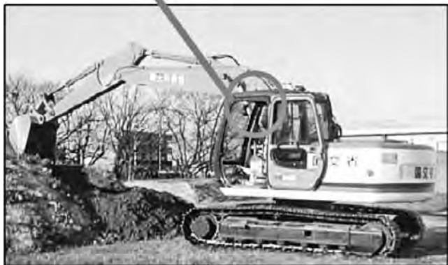
写真—15 360°カメラを用いた遠隔操縦 同時に全方位の動画を高画質で伝送可能。AIを搭載しており、人間の接近などを検知可能。
