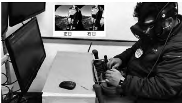
写真—14 VRを用いた立体映像による遠隔操作 左右の目に別の映像を見せることで立体を知覚する。より正確な操作が可能。
