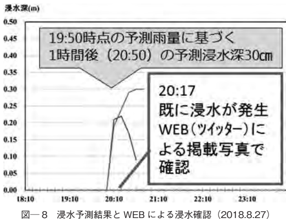
図一8 浸水予測結果とWEBによる浸水確認 (2018.8.27)
