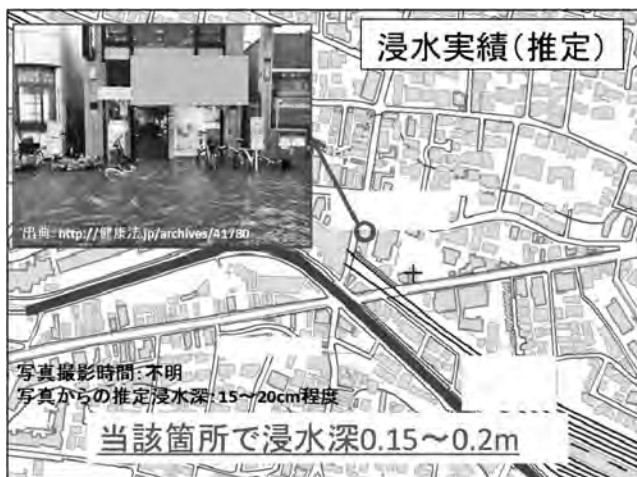
図一六 浸水状況写真からの浸水深判読結果 (2018.8.13)
