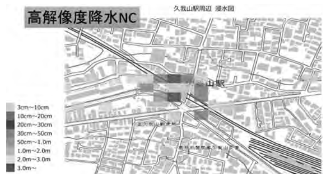
図一10 高解像度降水ナウキャストの予測雨量データに基づく浸水予測結果 (2018.8.13)
