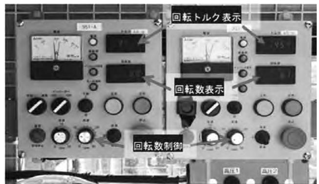
写真三 インバータモータによる回転数制御
