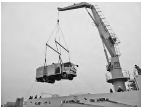
写真—12 10トンクレーン
