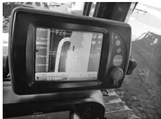
写真-1 ブルドーザー内 液晶画面
