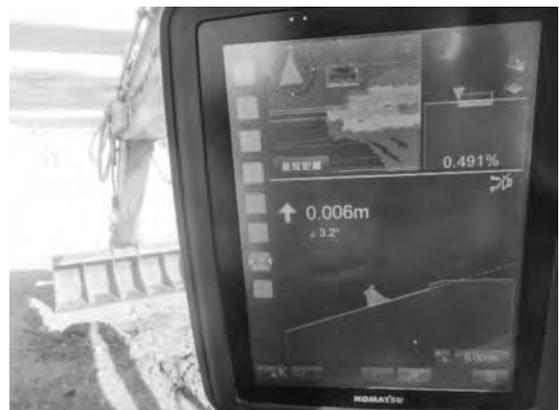
写真-2 バックホウ内 液晶画面
