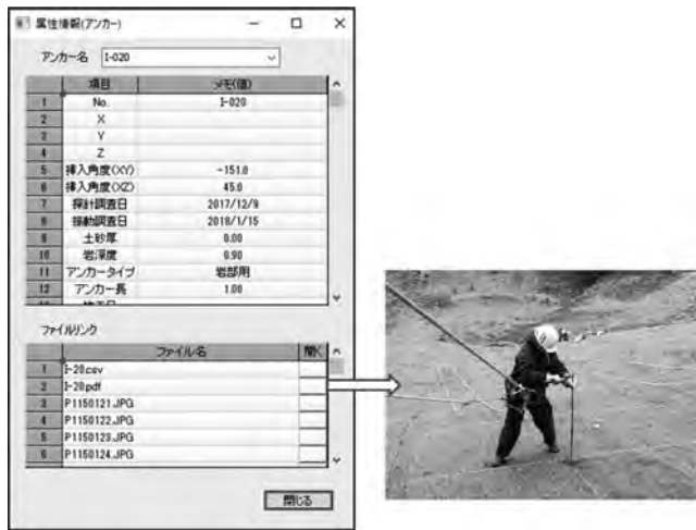
図-4 属性情報および施工写真表示例
