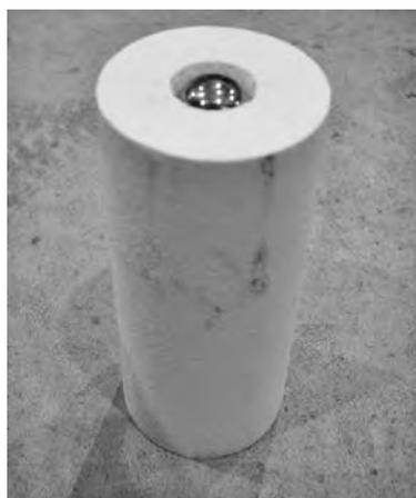
図-2 飛翔体（鋼球）が埋め込まれたサボの外観
