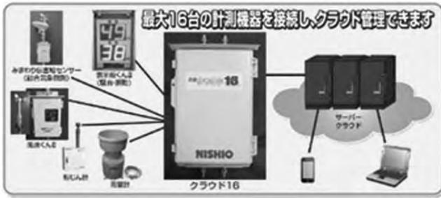
クラウド計測システム「クラウド16」の接続イメージ
