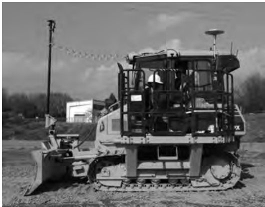
図-6 準天頂衛星測位システム搭載 3D-MC ドーザ 3)
