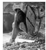
写真-19 エキセントリックリッパ
