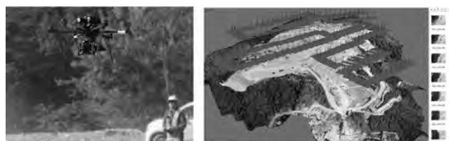
写真-20 UAV の自律飛行空撮と写真解析ソフト
