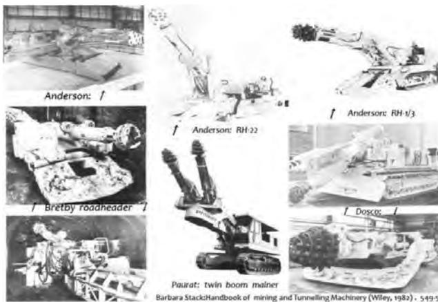
(2) カッターヘッドの縦軸型と横軸型の形状 (比較)
