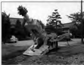
1972年鉄道建設公団青函トンネルへ納入 MRH-S45、カッター出力:45kW 重量:17t (三作製)
