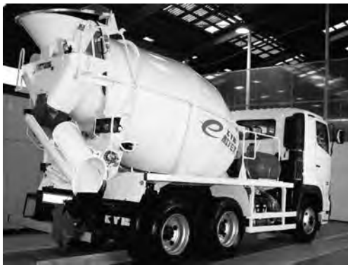
写真一11 電子制御式トラックミキサ
