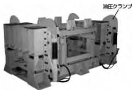
写真-23 大型セグメント製造用テーブルバイブレータ
