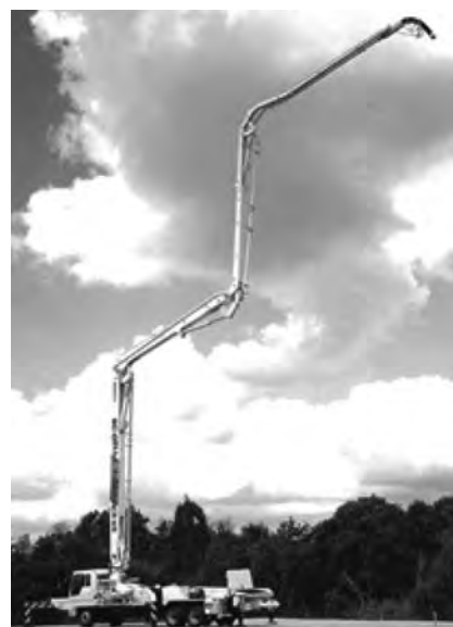
写真一13 ブーム付コンクリートポンプ車 (M型4段屈折36mブーム)
