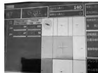
写真一 6 タブレットによる施工済箇所の確認 (SCM 工法)
