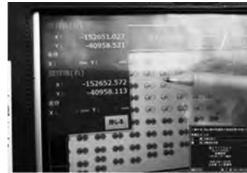
写真一 4 施工管理者用タブレット (RMP-MST 工法)
