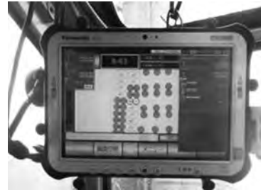
写真一 3 重機運転手用タブレット (RMP-MST 工法)
