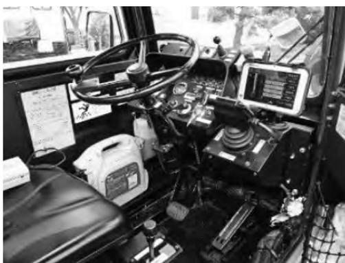
写真—10 歩道除雪車用ガイダンス装置
