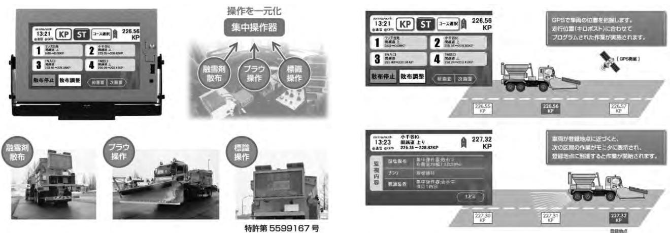
図-21 『集中操作器』概要と運用例
