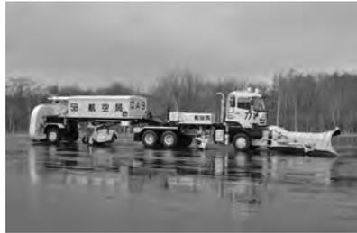
写真-18 空港用除雪トラック (スノーパ除雪装置牽引)
