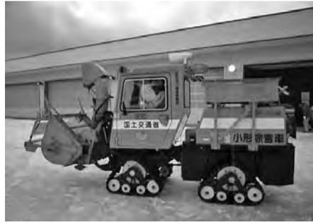
写真一七 クローラ式災害救助除雪車
