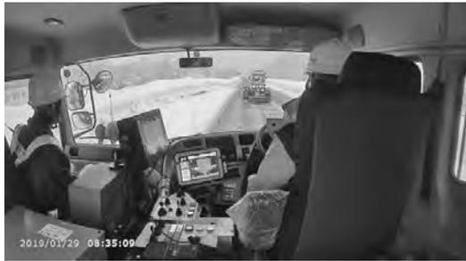
写真-12 ガイダンスを使用した除雪作業
