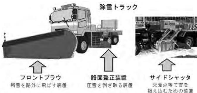
図-7 除雪トラック外観と自動化検討装置
