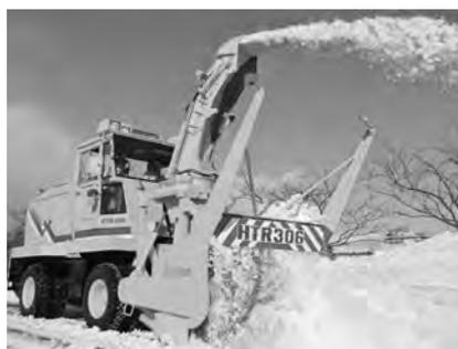
写真-2 中大型ロータリ除雪車
