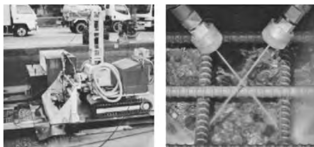
写真—10 ウォータージェットによるはつり性能評価試験
