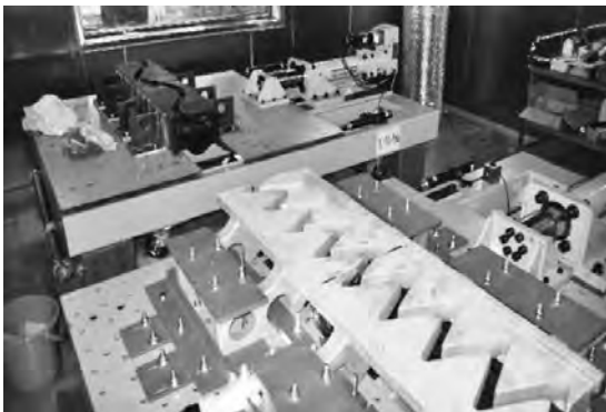
写真-14 橋梁伸縮装置止水構造の性能評価試験
