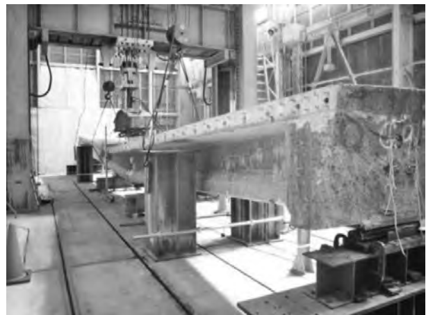
写真一7 PC桁の載荷試験
