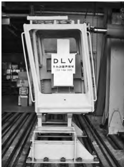
写真一六 ROPS 側方載荷試験状況
