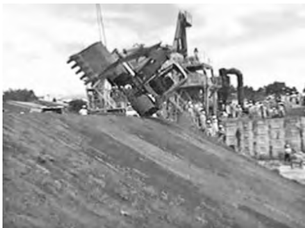
写真一 2 油圧ショベル転倒時保護構造の性能基準策定
