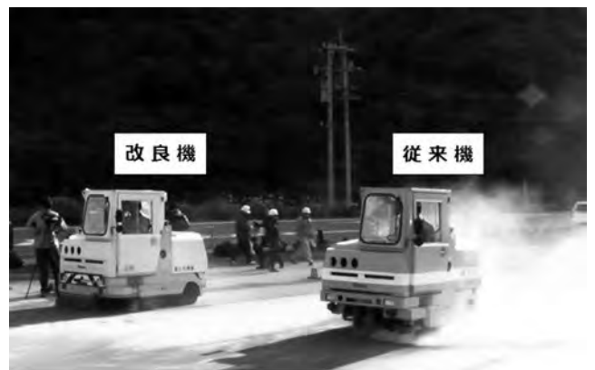
写真-1 歩道 (小型) 清掃車の公開実験の状況
