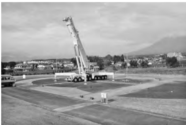
写真一七 音響パワーレベル測定状況
