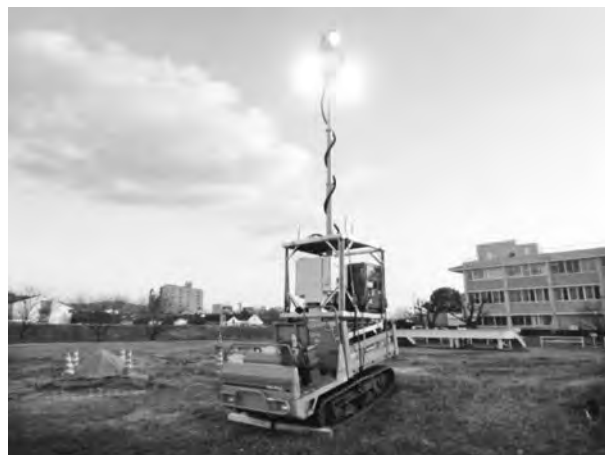
写真一 4 不整地運搬車に搭載した災害対策用照明装置
