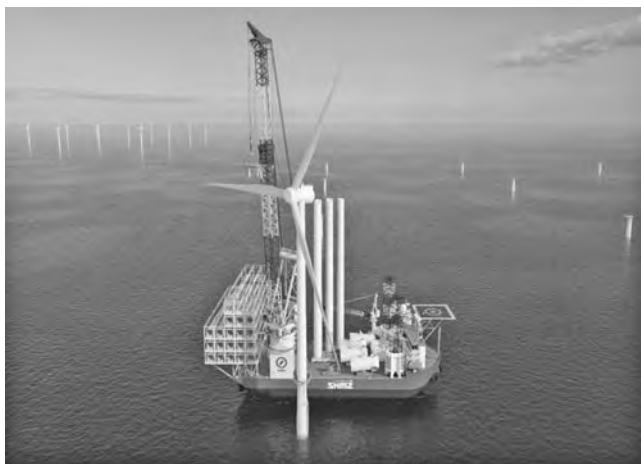
写真—9 世界最大級の搭載能力およびクレーン能力を備えた自航式 SEP 船
