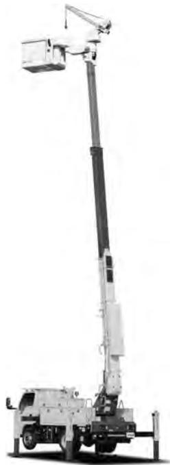
写真一六 アイチコーポレーション スカイマスター SN15C1FS トラック式高所作業車
