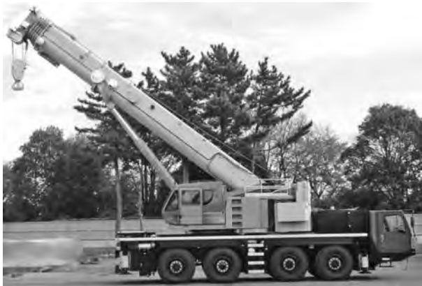
写真一八 全装備現場内移動姿勢（上部旋回体後方向）
