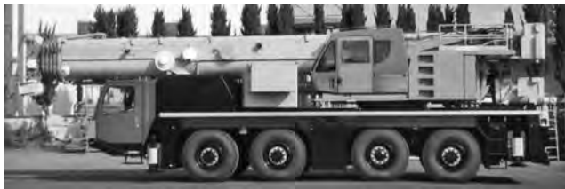
写真一七 全装備現場内移動姿勢（上部旋回体前方向）
