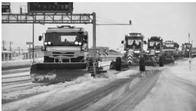
写真—1 除雪作業状況
