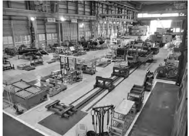
写真—7 クローラクレーン組立現場
