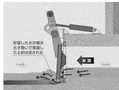
図一九 強制開閉装置による堆積土砂のフラッシング
