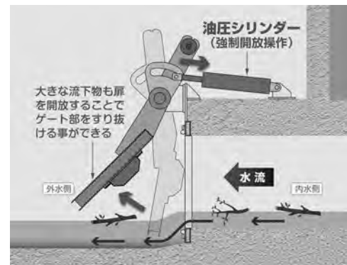
図一八 強制開閉装置による挟雑物の除去
