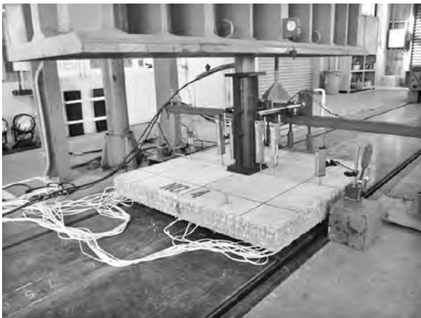
写真—5 FSC パネル耐力試験状況
