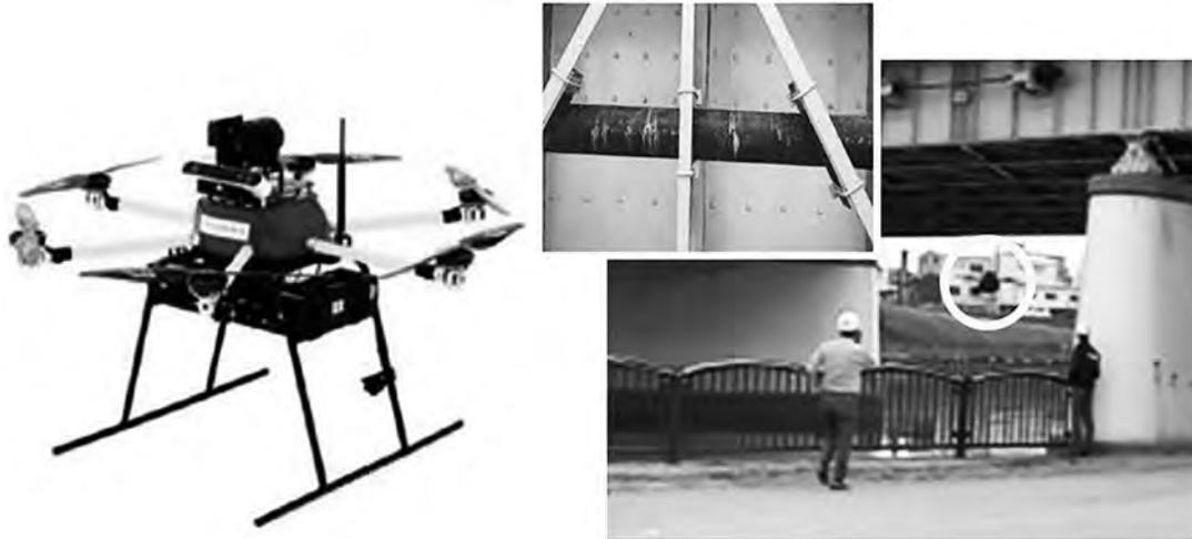
写真一4 非GPS飛行ドローン（開発途上タイプ）
