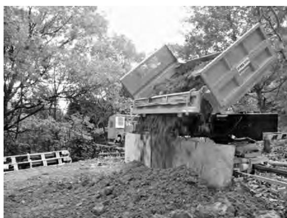
写真-4 サイドダンプで土砂を排出
