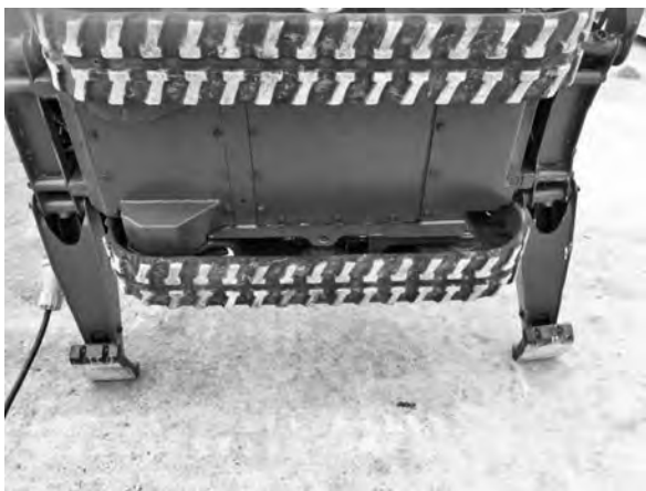
写真一5 横倒し状況での作動油漏れ未発生状況
