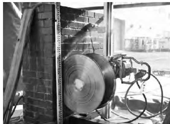
写真一5 2枚ブレードによる切断試験（ガイドレールにロードセルを設置）
