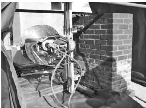
写真一5 2枚ブレードによる切断試験（ガイドレールにロードセルを設置）
