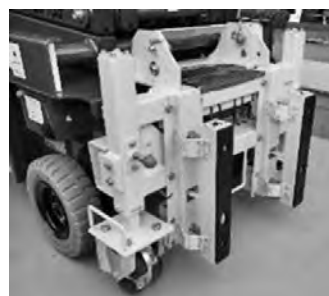
写真一 4 段差, 障害物検知センサー
