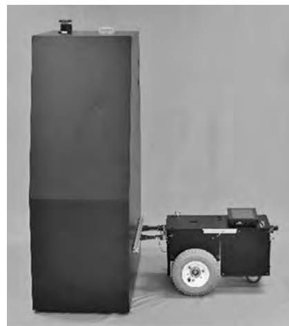
写真一 安藤ハザマ 自律走行式ひび割れ検査ロボット
