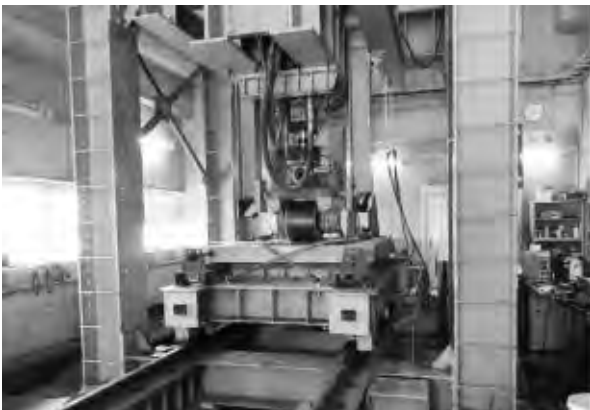
写真一三 輪荷重走行試験状況
