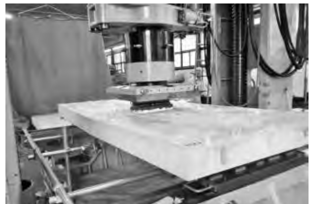
写真-2 静的曲げ試験状況
