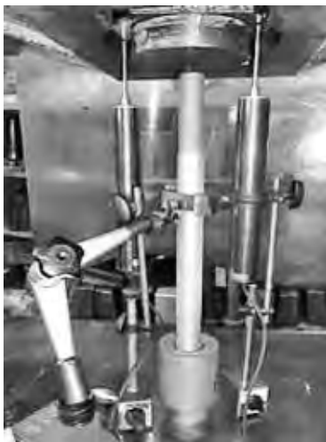
写真-1 押込み試験状況
