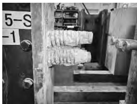
写真一 5 試験終了後のスタッドの状況
