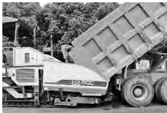
写真—5 中国大型ダンプ対応で延長したホッパ
