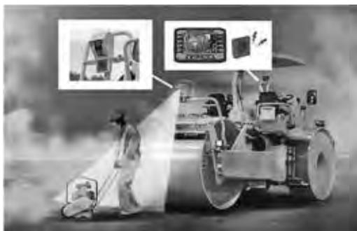
図-6 緊急ブレーキ装置の概念図
