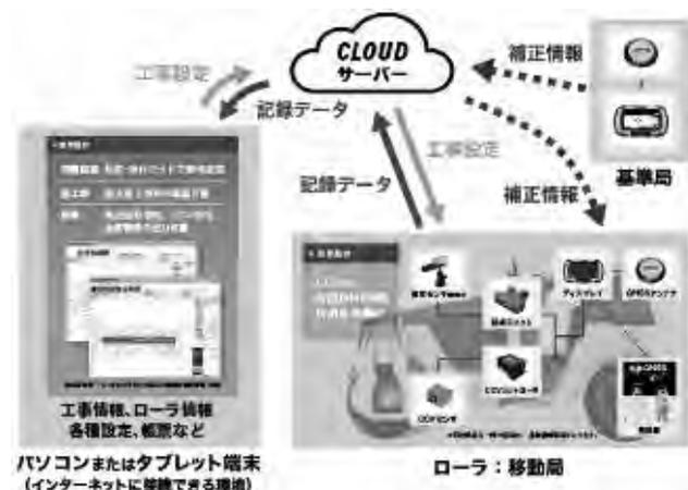
図-1 転圧管理システムの概要図
