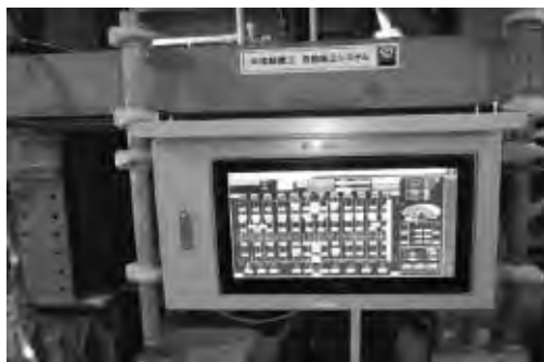
写真-12 打込み締固めモニター (展開)
