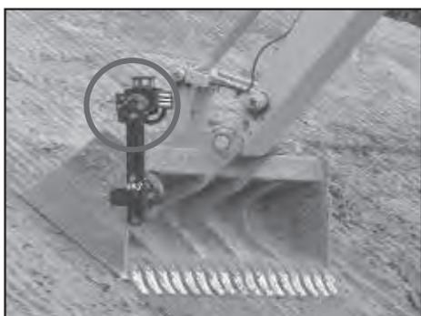
図一2 バケットの角度は勾配目視装置で確認
