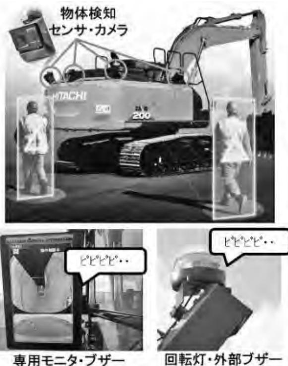
写真一五 物体検知、通知システムの構成
