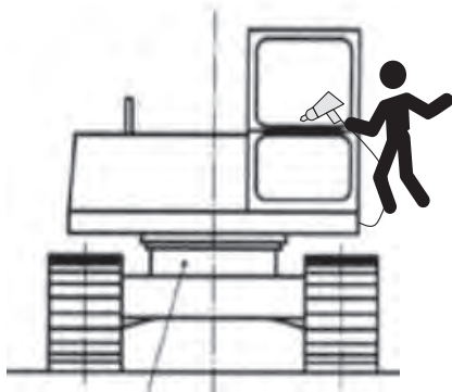
図-11 機器本体へのESD試験例
