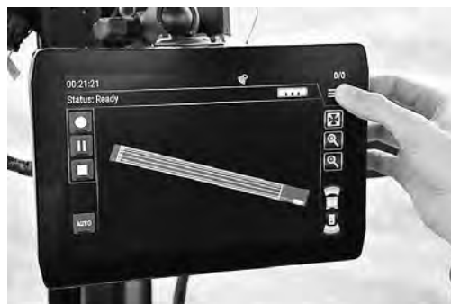
写真—2 Command for Compaction ディスプレイ
