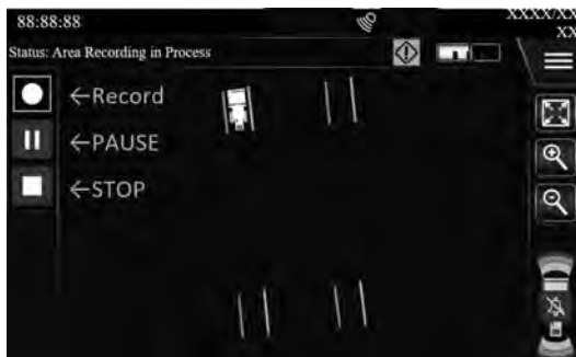
図-3 Record-Pause-STOP ボタンとポイント方式での設定：ディスプレイ (左)、転圧作業現場 (右)
