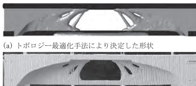
(b) 3D プリンティングで製作した PC 構造体
