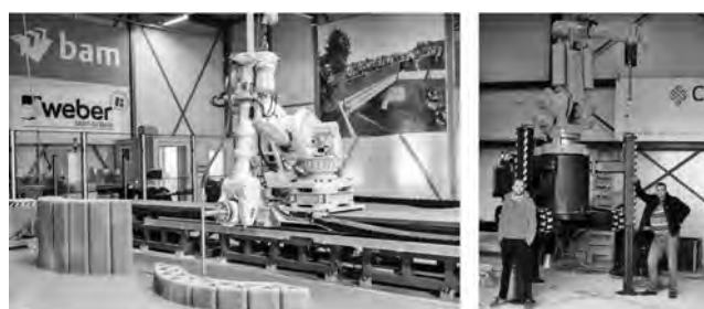
写真一 移動型3Dプリンタの事例（左：BAM Infra & Weber Beamix 9) 、右：CyBe Construction 10) ）
