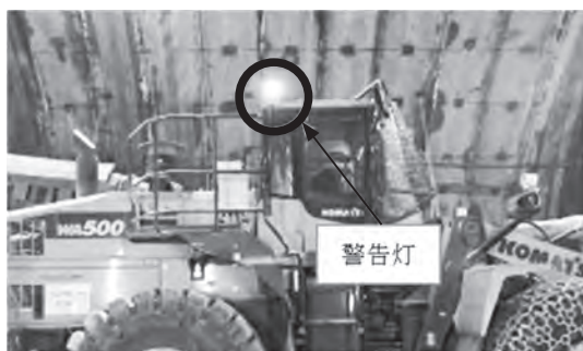
写真一五 警告灯点灯状況
