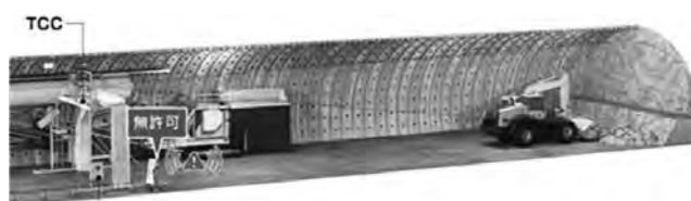
図—2 警告照明システム
