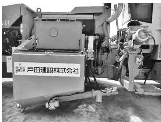
写真一 モルタル充填設備（材料投入時）
